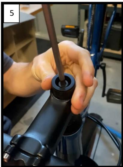
Après cela, vissez le capot supérieur jusqu'à ce qu'il soit en contact. (Photo 6). Ensuite, desserrez les vis de la potence. Re-serrez ensuite la vis du capot supérieur jusqu'à ce qu'il n'y ait plus de jeu dans la direction.
