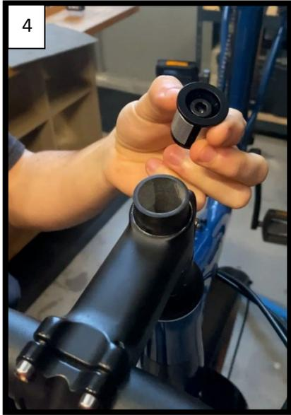
Utilisez une clé Allen, pour serrer l'expander à l'intérieur du pivot de la fourche (voir photo 5).
